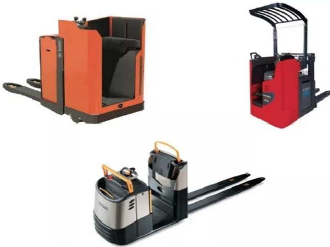
**Catégorie 1A : Transpalettes à conducteur autoporté** = chariots utilisés par les préparateurs de commandes sans élévation du poste de conduite (hauteur de levée  $\leq 1,20\text{m}$ ). Les transpalettes équipés d'une plateforme rabattable sont inclus dans cette catégorie.
