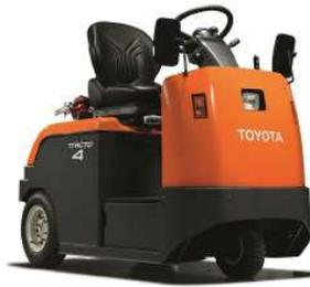
**Catégorie 2B : Chariots tracteurs industriels (capacité de traction inférieure ou égale à 25 tonnes)** – chariot de manutention muni d'un système d'attelage et spécialement conçu pour tirer des véhicules roulants (remorques...), dont la capacité de traction est inférieure ou égale à 25 tonnes.
