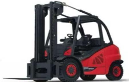
**Catégorie 3 : Chariots élévateurs frontaux en porte-à-faux** – Chariot élévateur à mât muni de bras de fourches, sur lesquels la charge est placée en porte-à-faux par rapport aux roues et est équilibrée par la masse du chariot, (capacité nominale  $\leq 6$  tonnes).
