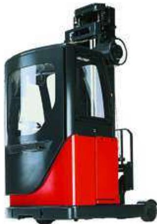
**Catégorie 5 : Chariots élévateurs à mât rétractable** – Chariot élévateur gerbeur à longerons porteurs pour lequel la charge peut être amenée en porte-à-faux par avancement du mât.
